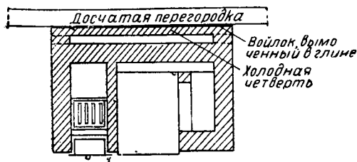
Рис. 39. Деталь установки кухонного очага у деревянной стенки.
